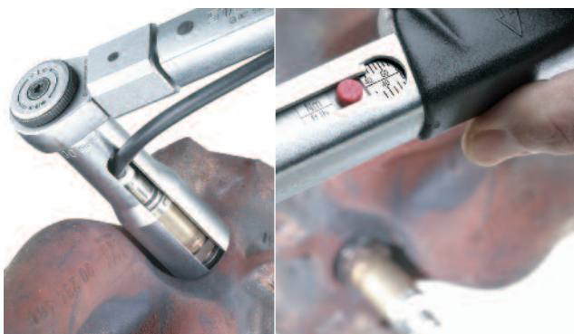
Wichtig: Das richtige Werkzeug zur Demontage / Montage der Lambda-Sonden. Empfohlenes Anzugsdrehmoment: 50 Nm
