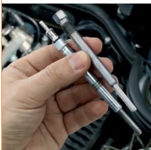
Die BERU Reibahle – löst Verkokungen, die nach dem „Verbacken“ zwischen Glühkerze und Zylinderkopf entstehen können.
