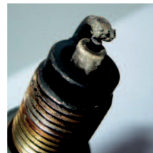
Cuadro de daños típico en caso de propulsión por autogas: una bujía de encendido sobrecalentada, ya que en la propulsión por autogas se produce mucho más calor. Consejo: Coloque una bujía de encendido con un valor térmico que sea 1 inferior.
