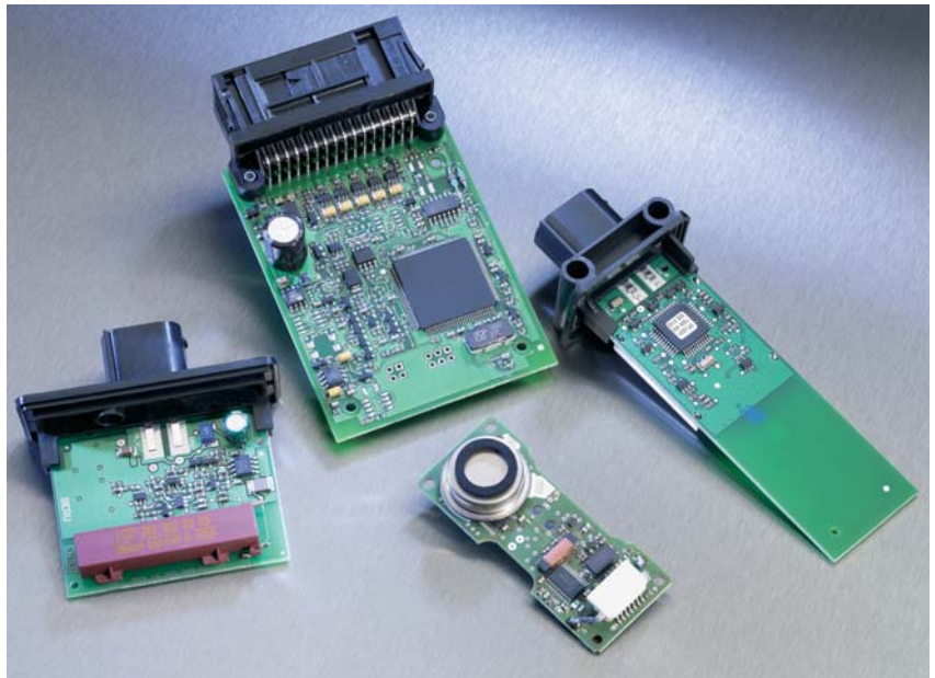
Bild 2: Komponenten des funkbasierten Beru Reifendruck-Kontrollsystems TSS; von links: Triggersender, Steuergerät, Radelektronik, Digitalantenne
