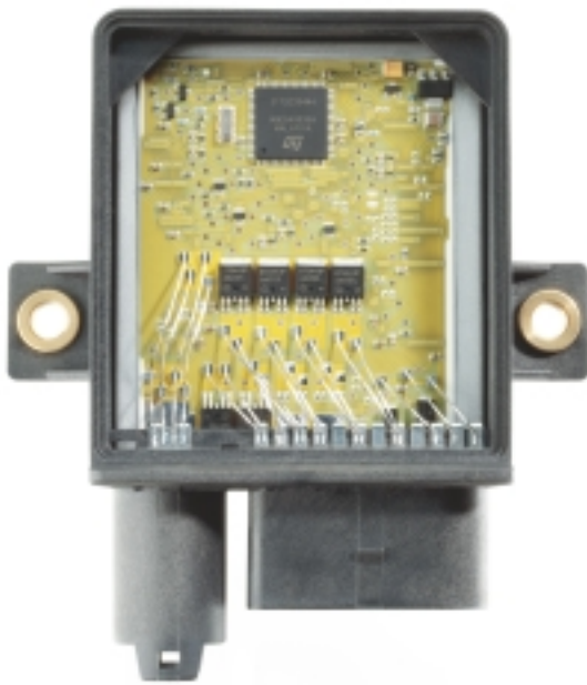
Bild 5: Motoranbaufähiges Glühkerzen-Steuergerät für einen Sechszylindermotor
