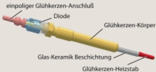
Bild 2: Aufbau einer Glühkerze mit Ionenstrom-Messfunktion
